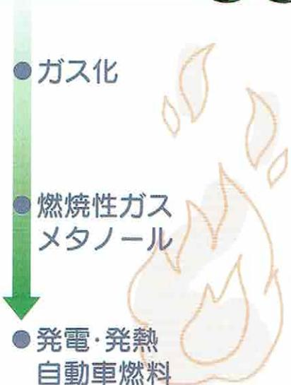
ガス化炉を通して有機物を熱分解し、水素、一酸化炭素などを生成させる。
