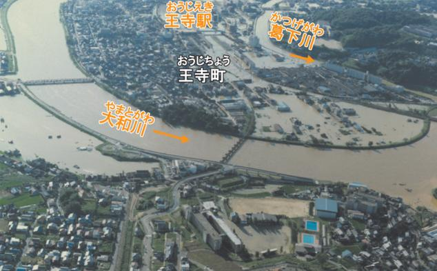
昭和57年8月「57水害」は王寺駅中心部が水没。亀の瀬の近い王寺町を流れる葛下川にバックウオーター現象が起き河川が氾濫したことが原因だった。死者・行方不明者は0人だったものの、家屋全半壊256戸の被害を出した。対策工事が進み、現在は当時と比べて氾濫リスクは低減しているものの、リスクが完全に除去されたわけではない。
