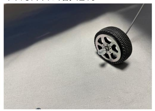
13 脚部の固定(\*タイヤを平行に) タイヤが平行になるように調整しながら脚用ピアノ線を固定します 平行になっていないと離着陸がしにくいので注意
