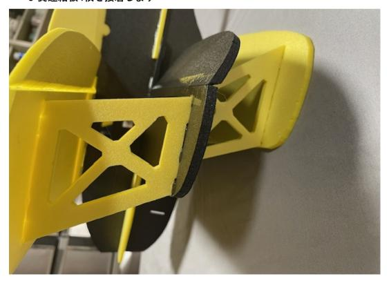
10 モーターマウント 動翼ホーン 脚部補強板を接着します
