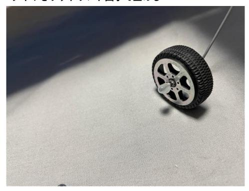
15 脚部の固定(\*タイヤを平行に) タイヤが平行になるように調整しながら脚用ピアノ線を固定します 平行になっていないと離着陸がしにくいので注意
